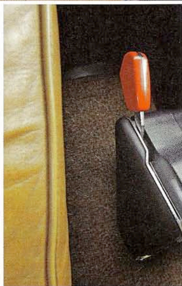
Die Gurtschnapper werden noch per Hebeldruck gelöst.
